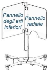
15. **Installare il pannello radiale** sulla superficie di fissaggio dell'asta telescopica utilizzando le viti zincate a testa cilindrica con esagono incassato M6x40 e le placche a compressione per i pannelli RIC001-01-08. Utilizzare la chiave esagonale da 5 mm per stringere le viti.
