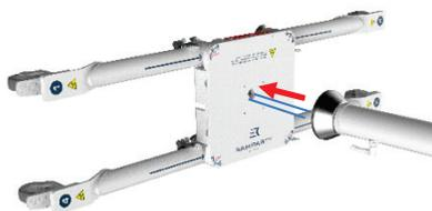
9. **Assicurare il gruppo dell'asta** con quattro viti M6x30 (viti a testa cilindrica con esagono incassato in acciaio inox con inserto autobloccante in nylon), inserendole nel gruppo della base e delle gambe e stringendole fino alla parte inferiore del gruppo dell'asta. Utilizzare la chiave esagonale da 5 mm per stringere le viti.
