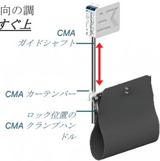
6. CMA カーテンバーを必要な予想高さに動かして CMA カーテンを垂直方向に調整し、CMA クランプハンドルを真下に回してカーテンをロックします。
