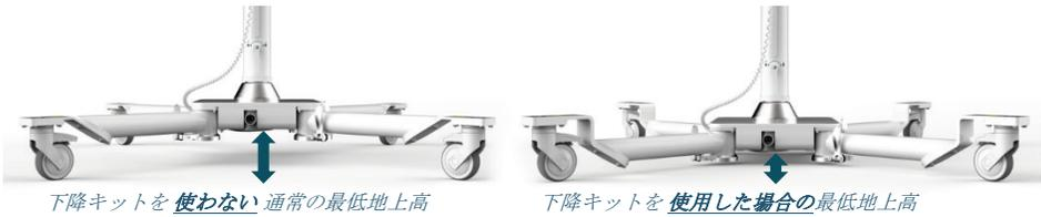
Rampart<sup>IC</sup> は、M1128 放射シールド全体の高さを 62 mm 下げるために別途購入できる M1128 下降キット (部品番号 M1128-LWK) を提供しています。これにより、改造された脚のあるベースブロックを準備することで、M1128 の重心を下げられます。下降キットを取り付けると、調整済み放射シールドの高さの最大値と最小値が 62 mm 減少します。
