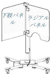
15. **ラジアルパネルの取り付け**は、亜鉛メッキの M6x40 ソケットヘッドキャップスクリューと RIC001-01-08 パネル圧縮プレートを使用して、伸縮マストの取り付け面に行います。5 mm の六角レンチで締め付けます。
